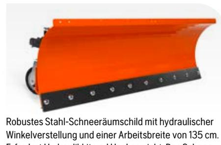
Robustes Stahl-Schneeräumschild mit hydraulischer Winkelverstellung und einer Arbeitsbreite von 135 cm. Erfordert Hydraulikkit und Heckgewicht. Das Schneeräumschild muss entweder mit Gleitkufen und Stahlleiste oder mit Stützrädern und Gummileiste kombiniert werden.
