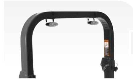
Ein am Überrollbügel befestigter Beleuchtungssatz, bestehend aus doppelten 35W-Halogencheinwerfern, die einfach angeklemt werden. Zum bequemen Bedienen über den Zündschalter wird die Halterung an den vormontierten Zubehörstecker angeschlossen.
