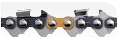
Halbmeißelkette (0.325"/1,5 mm). Erweitertes Sortiment im Bereich .325 Teilung. Eine Allrounder-Kette, die mit einer breiteren Schnittbreite für Motorsägen bis zu 55 cm<sup>3</sup> Leistung geeignet ist. Dank den Sicherheitsgliedern wird der Rückschlag minimiert. Teil der Erstausrüstung von Husqvarna 550 XP® Motorsägen.
