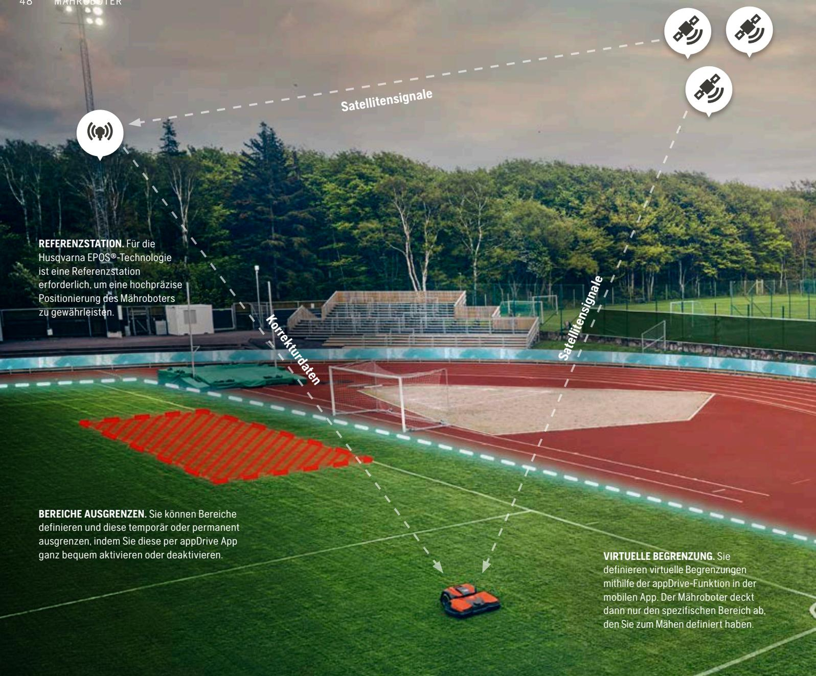
**REFERENZSTATION.** Für die Husqvarna EPOS®-Technologie ist eine Referenzstation erforderlich, um eine hochpräzise Positionierung des Mähroboters zu gewährleisten.
