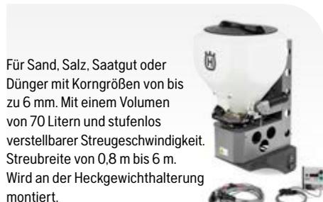
Für Sand, Salz, Saatgut oder Dünger mit Korngrößen von bis zu 6 mm. Mit einem Volumen von 70 Litern und stufenlos verstellbarer Streugeschwindigkeit. Streubreite von 0,8 m bis 6 m. Wird an der Heckgewichtshalterung montiert.
