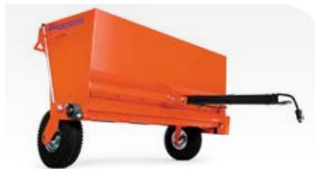
Robuster, hochwertiger Streuwagen mit elektrisch betriebener Streuwalze, die ein gleichmäßiges und zuverlässiges Streuen garantiert. Leicht einstellbarer Durchfluss. Das Schutzgitter an der Oberseite kann beim Befüllen mit Dünger, Salz, Sand oder feinem Kies bis zu einer Korngröße von 30 mm auch als Sieb verwendet werden. Für die Serie P524X ist ein Steckdosensatz erforderlich. Kann mit einer Kupplung für 50-mm-Kugelhaken ausgestattet werden.
