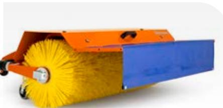
Rotierender Besen zum Kehren von Blättern, Schnee usw. Kann zu beiden Seiten abgewinkelt werden. Arbeitsbreite 120 cm. Besen für P524X verfügen über eine elektrische Winkeleinstellung. Muss mit einem Steckdosensatz (vorne) kombiniert werden.
