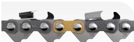
Für Anwender, welche die Vorzüge einer .325er Teilung kombiniert mit einem Vollmeißelzahn und präziser 1,5 mm Nut schätzen. Für Motorsägen mit 40–60 cm<sup>3</sup> Leistung.
