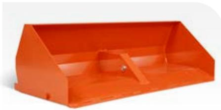
Hydraulisches Anwinkeln und Entleeren. Arbeitsbreite 120 cm. Ladekapazität 65 kg. Erfordert Hydrauliksatz und Heckgewicht.
