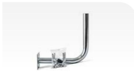
Halterung für RS5 EPOS®-Referenzstation. Abmessungen 300×250 mm, Durchmesser 32 mm. Für Wand- oder Mastbefestigung mit Ø30-60 mm. Stahl.
