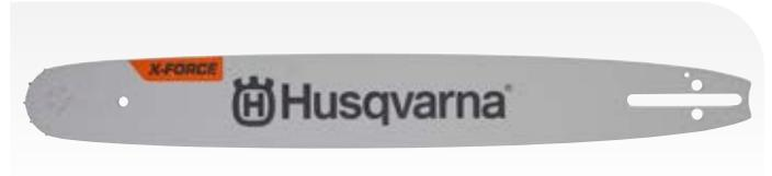
Die leichten, laminierten X-FORCE-Schiene mit reduzierten Wartungsintervallen und optimierter Standzeit. Dank dem geringen Gewicht, das durch die Aussparungen im Schieneninnenkorpus möglich ist und den Komponenten in der Sternspitze störungsfrei gearbeitet werden. Erhältlich in 3/8" (15–20 Zoll), 3/8" mini (12–16 Zoll) und 0.325" (13–20 Zoll).
