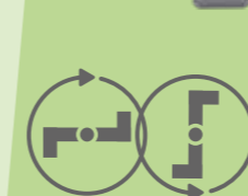
Aufbau des Mähdecks mit synchron-laufenden Messern
