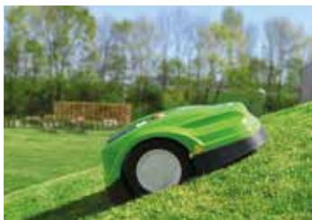
Die iMow Robotermäher bewältigen Steigungen und Gefälle bis 45%.
